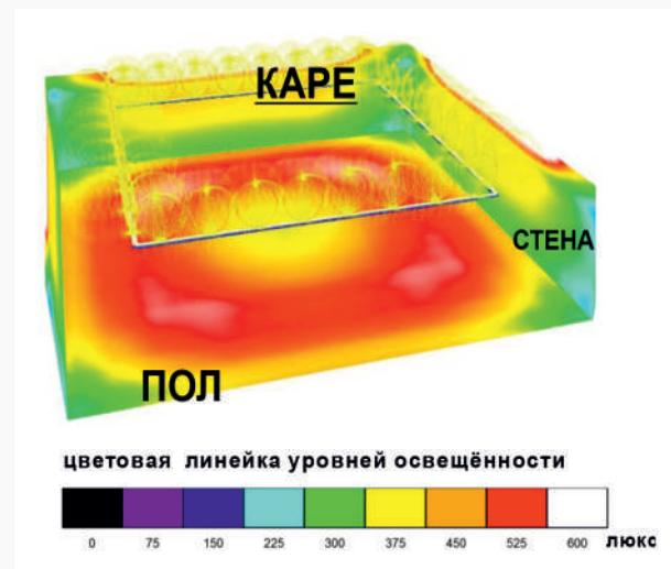
Уровни освещённости пола и стен в помещении 12 x 12 x 2,8 м, освещённом подвесной системой типа КАРП, собранной из модулей «СВЕТ ЗДОРОВЬЯ» общим размером 8x8 м:
