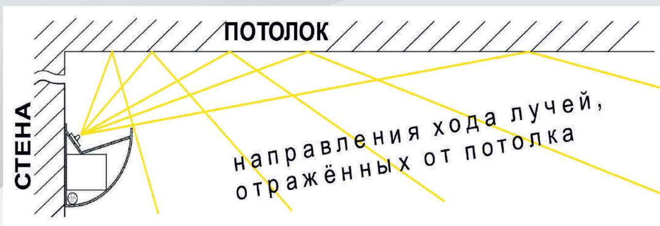
Конструкция светильника с углом рассеивания и равномерного освещения
